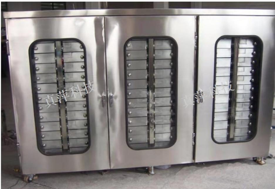
下面为大家介绍一下石墨盘真空烤盘炉的用途和设计。一、产品介绍真空烤盘炉是与MOCVD设备配套使用的炉体，炉内抽真空，被处理工件放置在炉膛内，采用清洗气体加热反应方式进行干式清洗（清洗气体 $N_2$  $H_2$ 主要用于有效清洗除MOCVD承受器 $SiC$ 涂层石墨盘或石英盘）上的氮化镓和氮化铝等，可达到有效清洁处理，提高制品质量的目的。二、设计特点1. 后门设计热风电机2. 降温时风机开启，同时两端降温封头开启，炉膛内产生如图所示的气体流向3. 通过气体介质将隔热层内与水冷壁之间进行热交换，达到快速降温的目的。试验箱联系方式试验箱如何发挥重要作用？合肥真萍告诉您。
